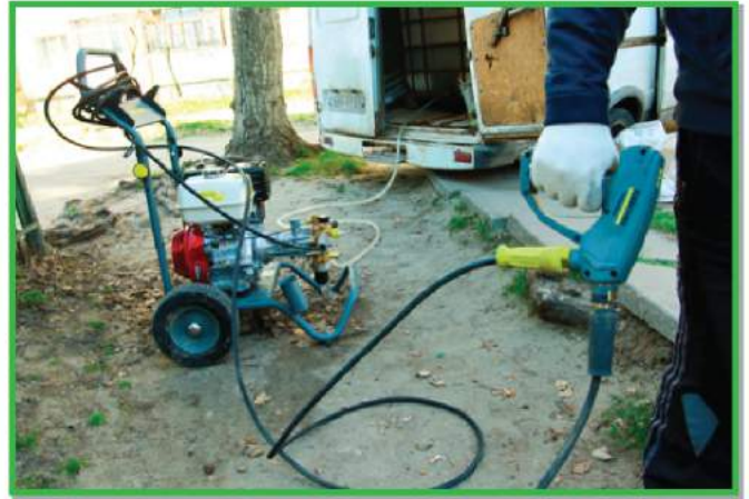
Апарат високого тиску для очищення каналізаційних зливів
